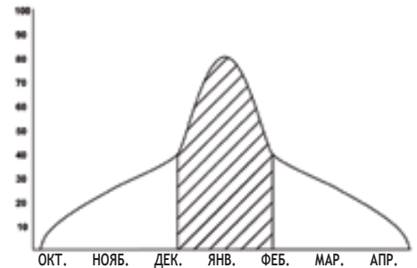
Рис.6 Площадь максимальной производительности котлом с двухпозиционной горелкой на 150 кВт
